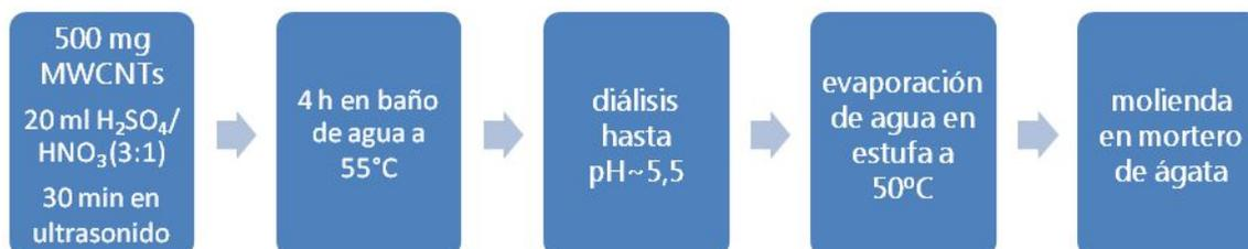
Figura 8. Esquema de oxidación de los MWCNTs comerciales.
