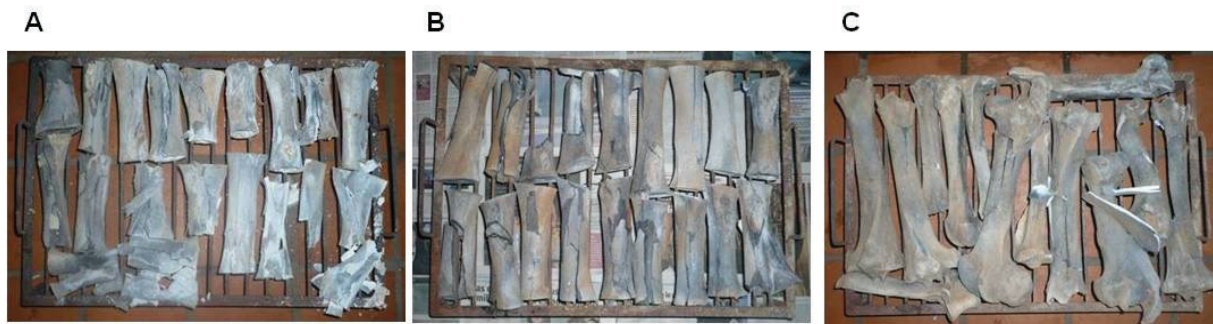
Figura 2-6. Color del carbón de hueso obtenido por destilación seca en un horno de barro a leña de los lotes de fémures vacunos I (A), II (B) y III (C).
