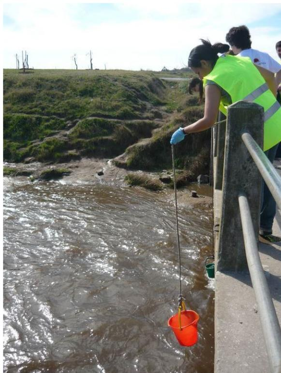
Figura 2.08. Equipo de muestreo de aguas superficiales utilizado en todas las campañas.
