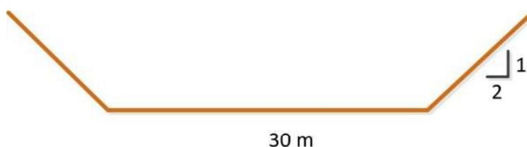
Figura 1.15. Corte transversal y dimensiones de la segunda sección del río Reconquista.
