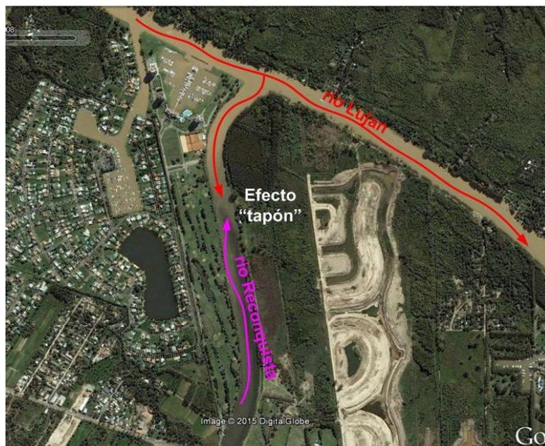
Figura 4.18. Foto satelital de la desembocadura del río Reconquista, a través del canal Aliviador, en el río Luján. Se ilustra el ingreso de las aguas del río Luján, las cuales evitan el drenaje de las aguas del río Reconquista: efecto “tapón”.
