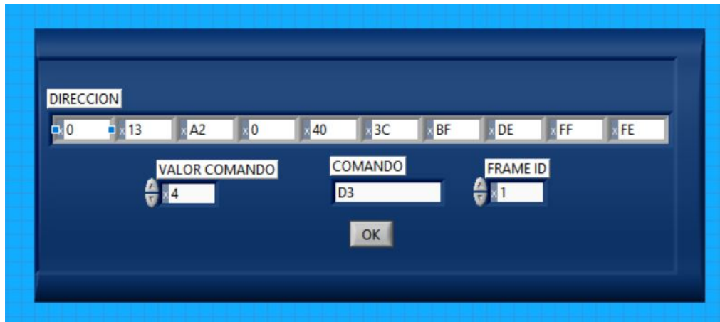
Figura 8.21: Panel de configuración para envío de comando remoto.
