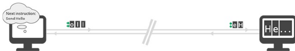
Figura 4.7: Comunicación Transparente entre módulos XBee.
