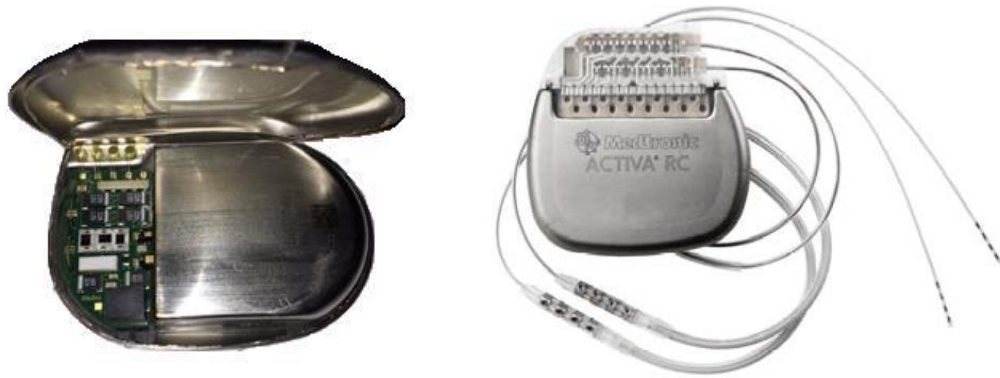
Figura 1) Neuroestimador para humanos marca Medtronic, modelo SOLETRA (izquierda) y ACTIVA (derecha).
