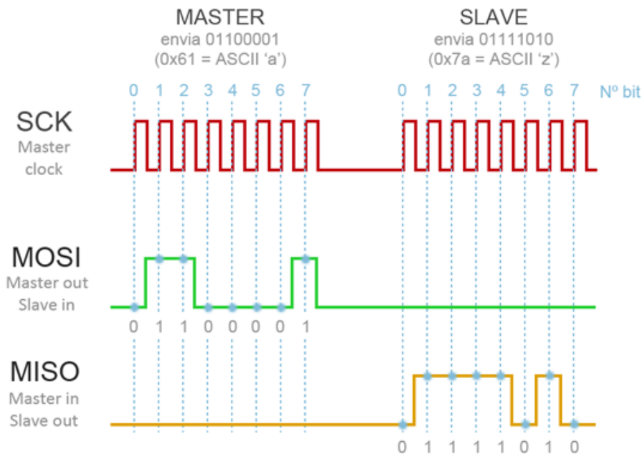
Figura 9) Ejemplo de envío de datos (secuencia de bits) mediante un Bus SPI.
