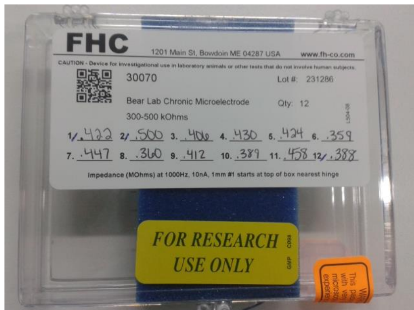
Figura 16) Electrodo utilizados para la estimulación y el registro.
