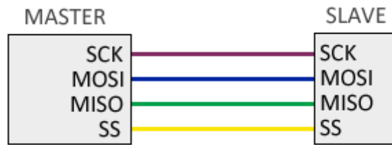
Figura 7) Esquema comunicación Bus SPI.
