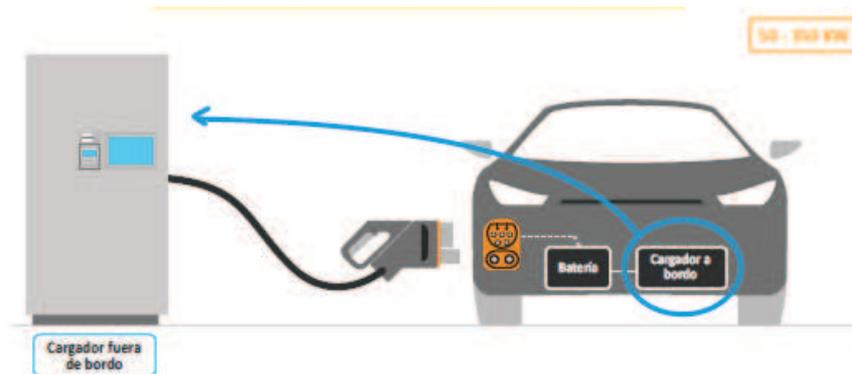
Ilustración 28 Carga en CC. con cargador-conversor externo.
