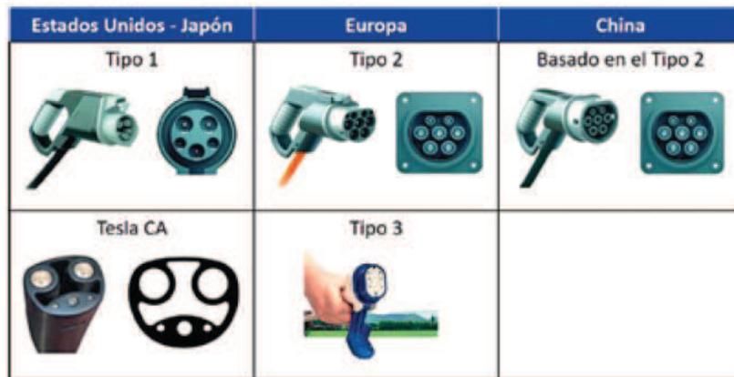
Ilustración 29 Tipos de conectores para CA, según región de fabricación.
