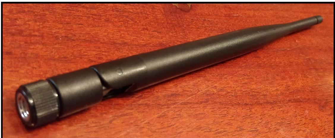
Figura 4.1.4.1. Fotografía de una antena LoRa.
