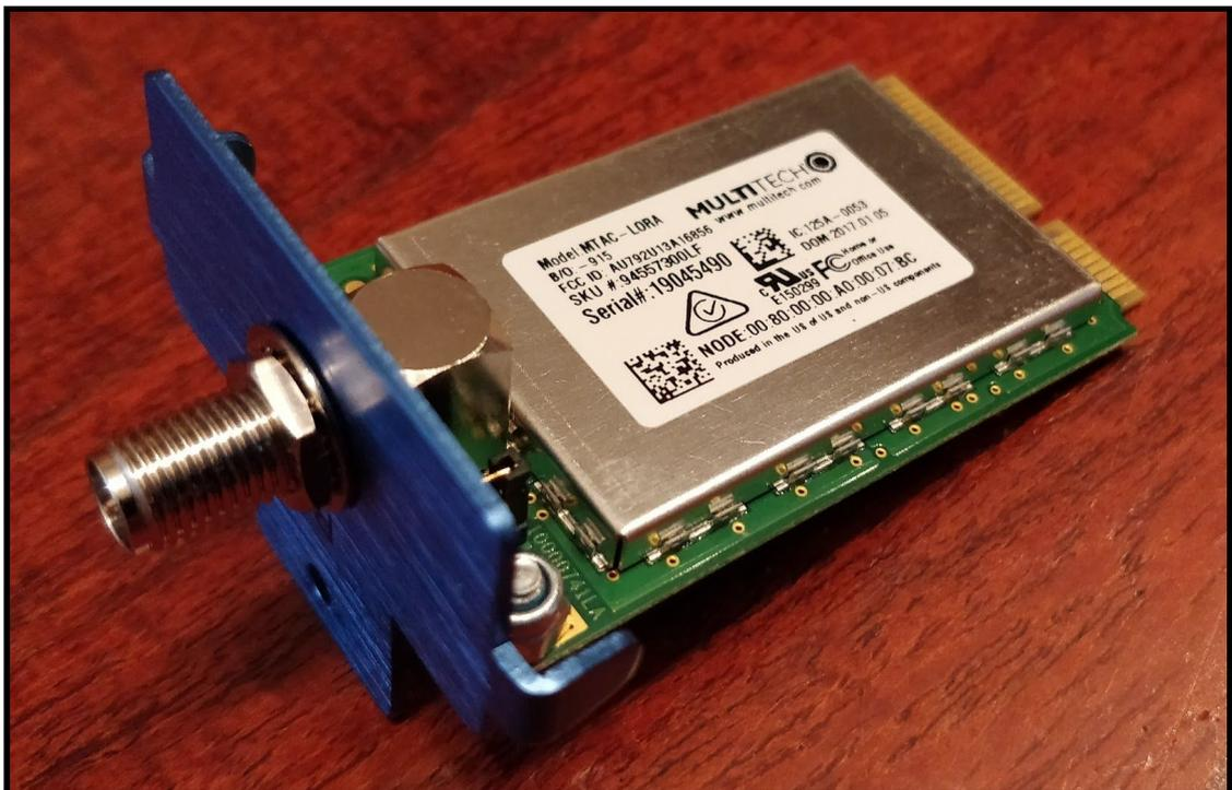
*Figura 4.1.1.1. Fotografía del Módulo LoRa que se conecta al Gateway Conduit.*
