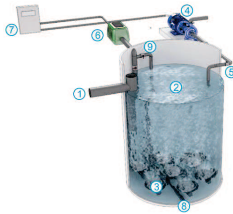
Figura 16: Esquema de un tanque de homogeneización. Fuente: Google Imágenes.
