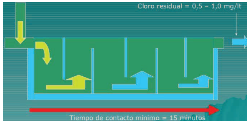
Figura 29: Esquema de una cámara de cloración. Fuente: Google imágenes.
