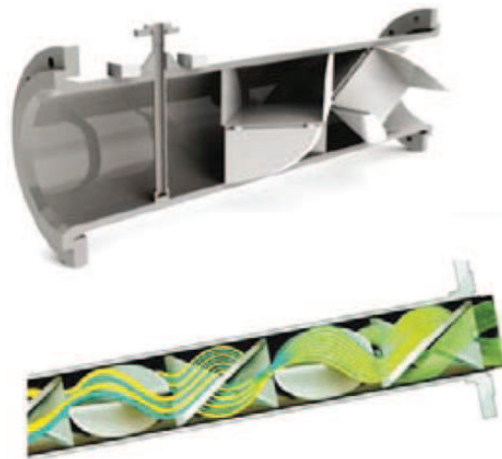
Figura 43: Representación de un coagulador estático. Fuente: Google imágenes.
