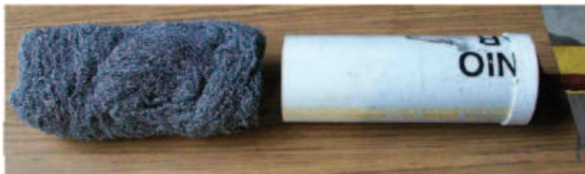
Figura 6.17: Ejemplo del sistema de filtro de Sulfuro de Hidrógeno
