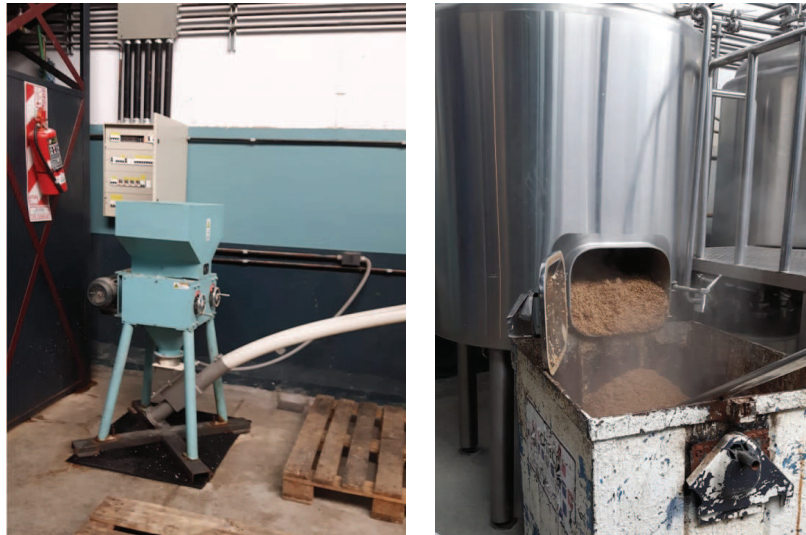
Figura 3.3: Dispositivos de molienda (izq.) y macerador con plato falso (der.) de Cervecería A
