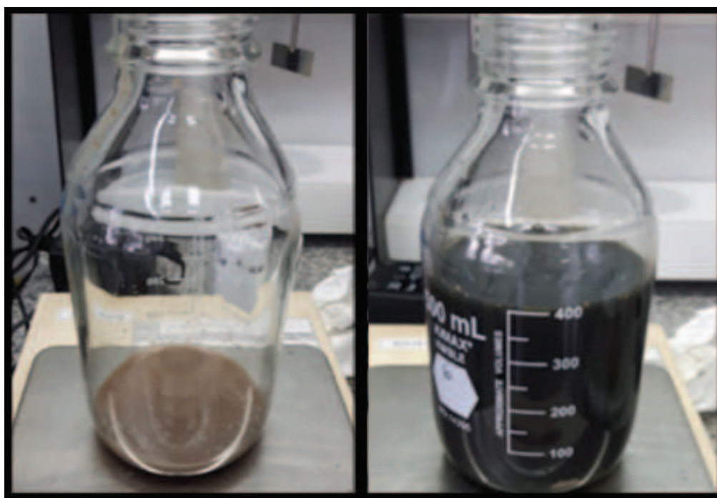
Figura 4.6: Imagen ilustrativa de la carga del reactor con el sustrato (izq.) y con el posterior llenado del inóculo (der.).
