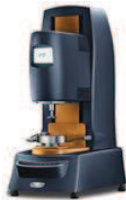
Figura 2. 8: Reómetro TA Discovery III empleado en el trabajo. La superficie de apoyo es una celda Peltier que permite conservar la temperatura en un rango entre -40 °C a 200 °C; en el soporte superior pueden colocarse diversas geometrías según el tipo de muestra y el ensayo que desee realizarse.
