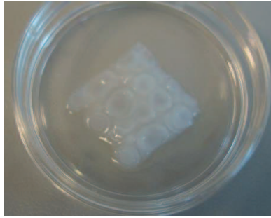
Figura 2. 17: Impresión de la grilla empleando quitosano 3,44% entrecruzado en la primera jeringa con hidróxido de sodio 0,5M en la segunda jeringa
