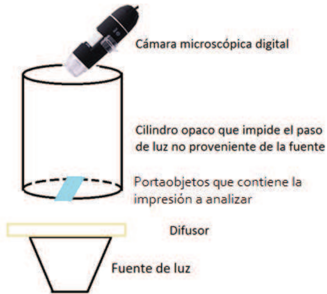
Figura 2. 16: Esquema del sistema de adquisición de imágenes para el análisis de imprimibilidad.
