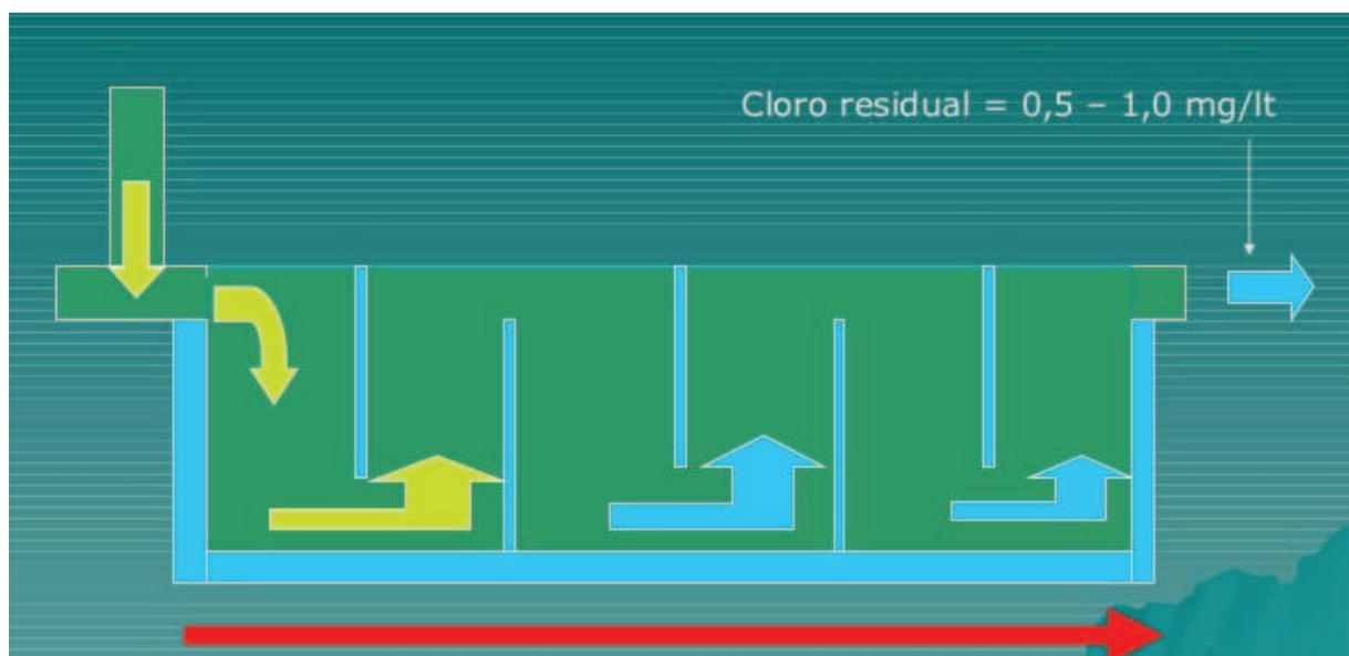
Figura III.V.I Esquema de la cámara de cloración. Fuente: Dr. Lucas Bouchard Señoret, Cloración en salud pública.
