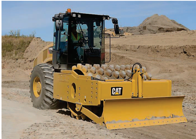
Figura 26: Compactador de suelo vibratorio CAT CP68B.
