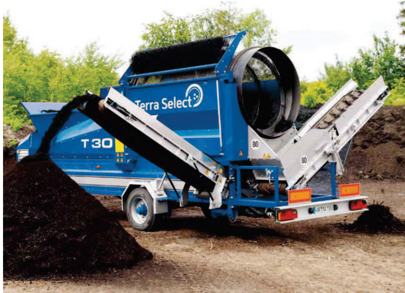
Figura 22: trommel Eggersmann Terra Select T30.
