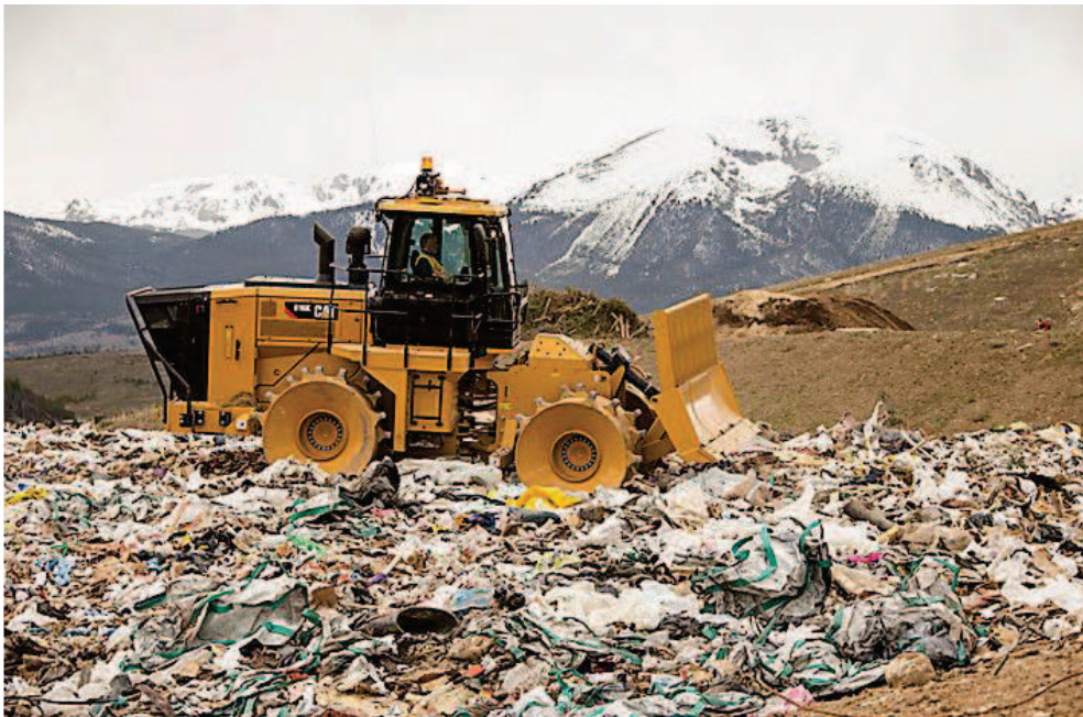
Figura 24: Compactador de rellenos sanitarios CAT 816K.
