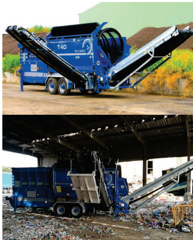
Figura 18: Trommel Eggersmann Terra Select T40.
