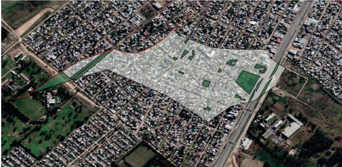
Figura 46: Clasificación de la cuenca según coberturas, área de concreto/techo (en blanco) y zonas verdes de condición buena y pendiente plana (en verde).
