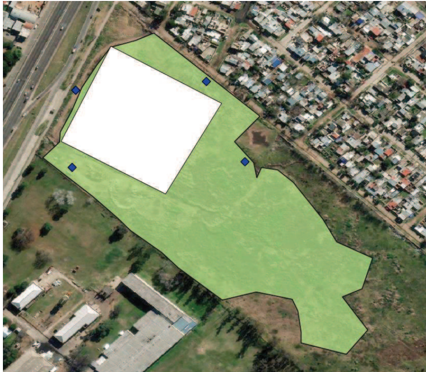
Figura 48: Ubicación de puntos de muestreo de red de monitoreo de agua subterránea.
