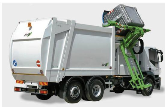
**Figura 4.2.3: Camión recolector de carga lateral**
