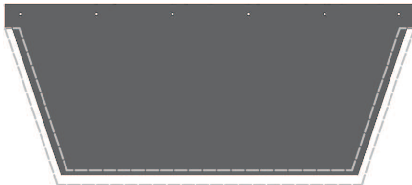
Figura 17b. Compuerta de chapa galvanizada con detalle del encastramiento en el canalizado (Fuente: Elab. propia).
