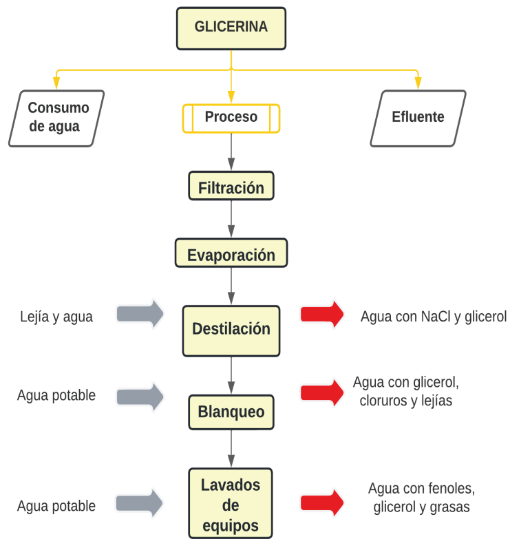
Figura 15. Puntos de generación de aguas residuales en el proceso de obtención de Glicerina. Fuente: propia
