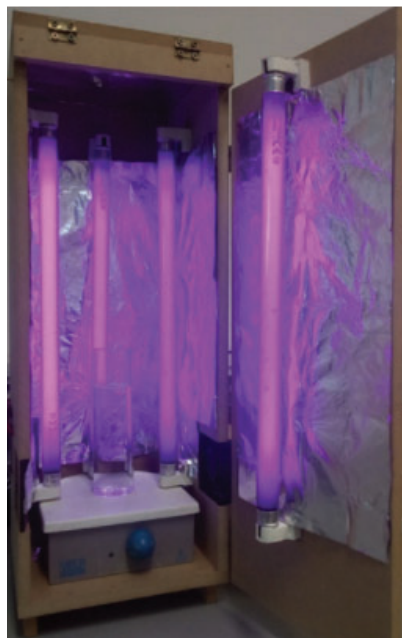
Fig. 3.1: Reactor utilizado para proceso foto-Fenton, compuesto por un agitador magnético, lámparas de luz ultravioleta y un sistema de ventilación que permite mantener la temperatura constante.
