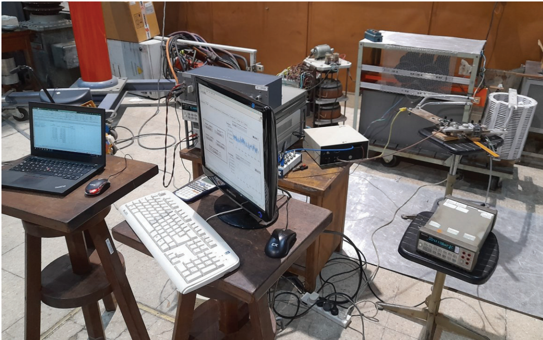
Figura 40. Imagen del sistema de referencia de potencia y energía armado. Se observa a la derecha los resistores shunt.
