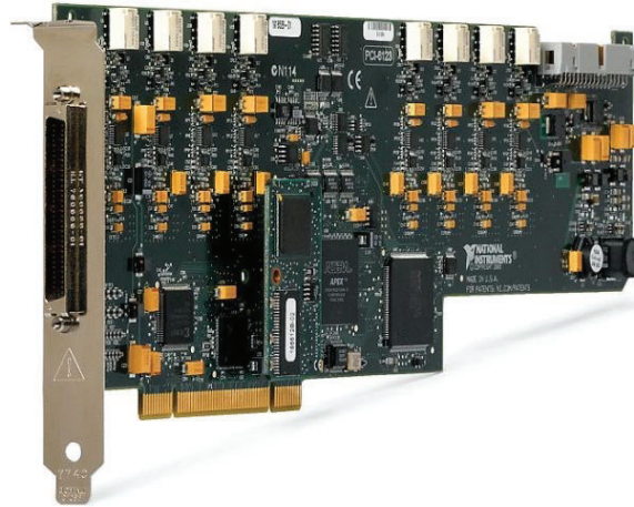
Figura 11. Imagen de la placa de adquisición NI-6133. Imagen extraída de internet ver [15].
