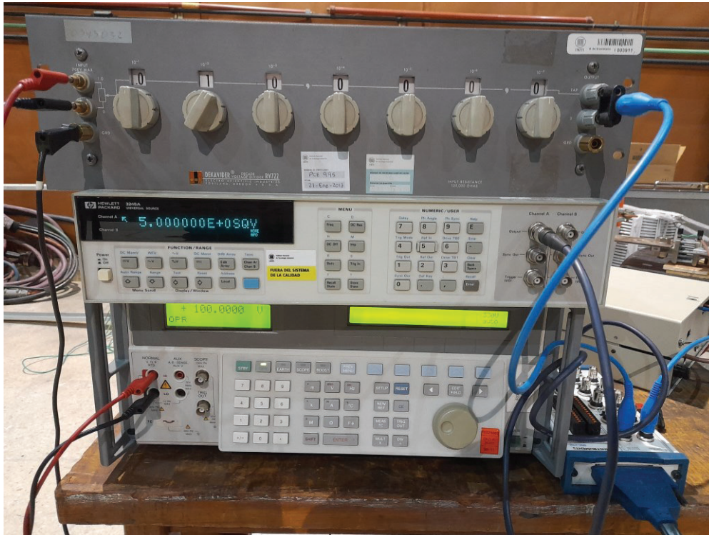
Figura 42. Imagen del calibrador Fluke 5500, fuente HP 3245A, Divisor resistivo RV-722, bornera BNC 2110 y la etapa de acondicionamiento.
