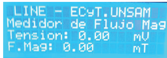
FIGURA 4.10: Muestra de datos e información por medio de la pantalla display LCD.
