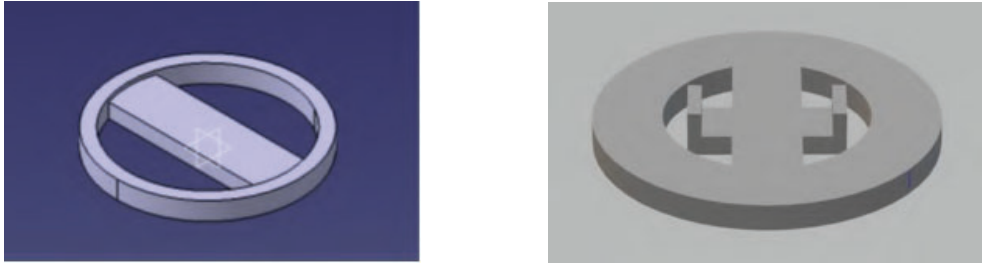
FIGURA 3.1: Diseños de la platina. En la imagen de la izquierda se consideró una zona central para la ubicación de las muestras mientras que los electroimanes serían enhebrados lateralmente. Alternativamente, el diseño de la derecha considera dos alas de las que sujetar el eje de las bobinas.
