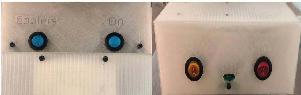
Figura 3.27: Rediseño de tapa que contiene la electrónica.
