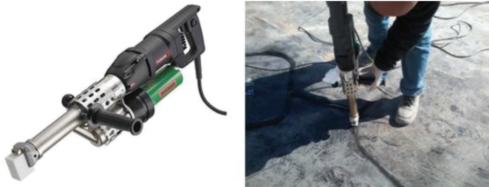
FIGURA 33 EXTRUSORA MANUAL LEISTER FUSION 3 (FUENTE: (Coripa, 2023))
