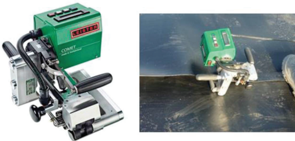
FIGURA 32 SOLDADORA AUTOMÁTICA DE CUÑA CALIENTE LEISTER COMET. (FUENTE: (Coripa, 2023))
