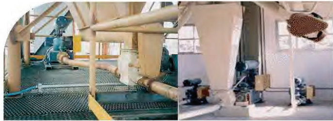
Uso en transporte neumático por presión positiva
