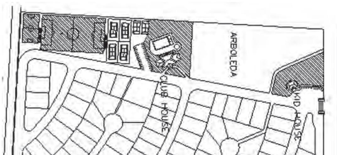
Figura N° 49. Área de riego de zonas verdes comunes. Fuente. Elaboración propia.
