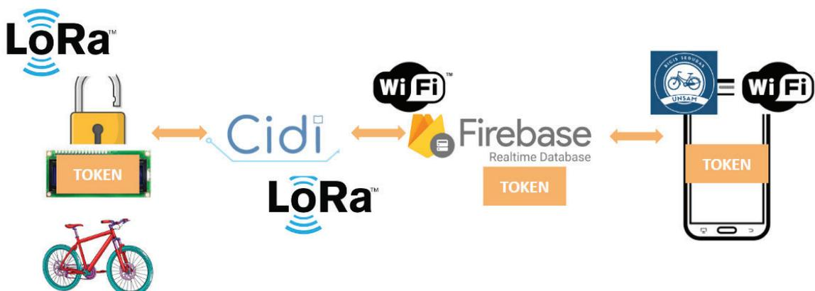
Imagen 3. Esquema básico de comunicación
