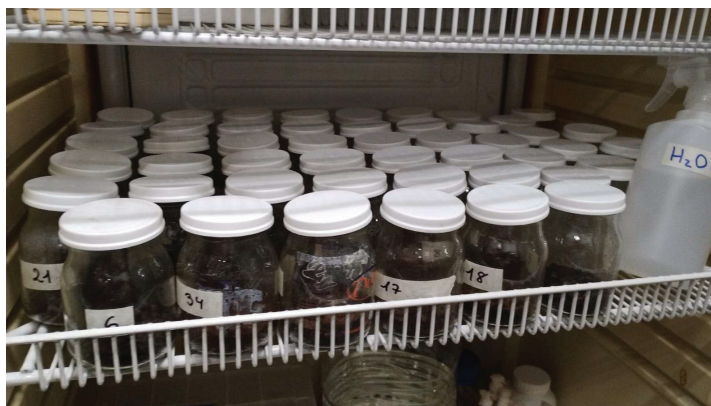
Figura 20: Microcosmos puestos en incubación a 20 °C en oscuridad. Se encuentran ambos grupos de análisis, y el agua destilada empleada en mantener la humedad requerida semanalmente.
