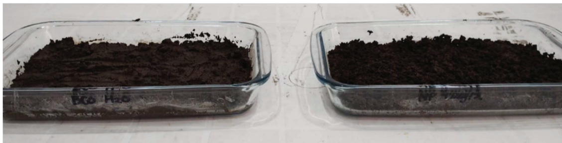
Figura 19: Bandejas de vidrio conteniendo el suelo muestreado. A la izquierda, suelo humectado con agua destilada; a la derecha, suelo embebido con solución acuosa de NP 4 mg/L.
