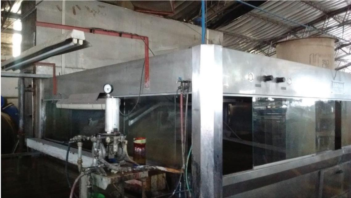
**Figura Anexo 13:** Registro fotográfico - Cabina de pintura por spray automático rotativo.
