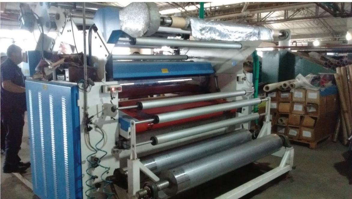
**Figura Anexo 12:** Registro fotográfico - Máquina laminadora.
