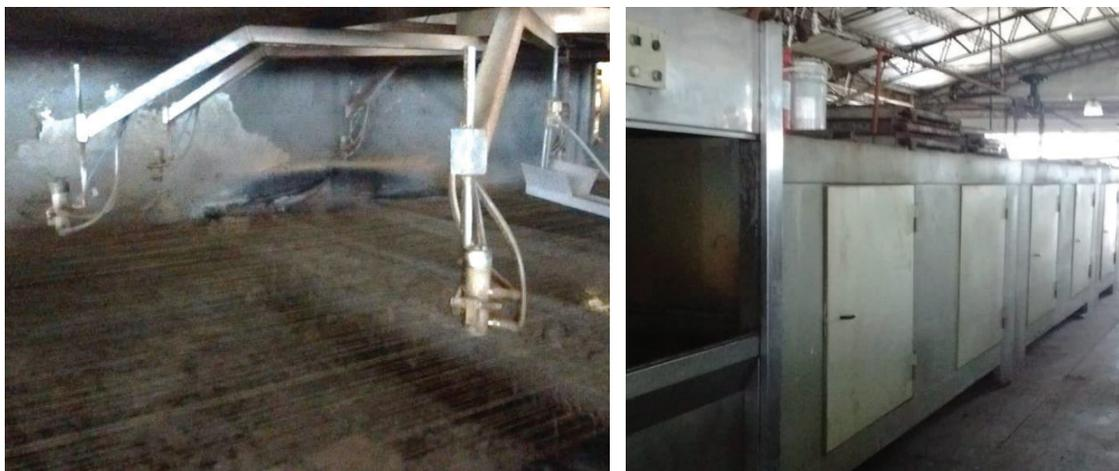
**Figura 8:** Izq.: Cabina de pintado con revolver automático, para la aplicación de la capa de terminación. Der.: Túnel de secado. Ambas fotografías fueron obtenidas durante una de las visitas realizadas a curtiembres.
