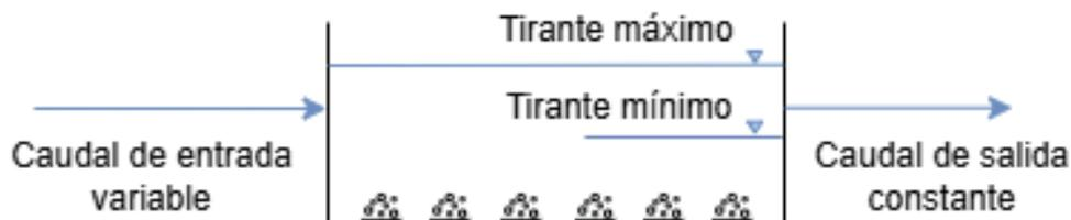
Figura 24: Esquema de ecualizador. Adaptado de referencia [21].
