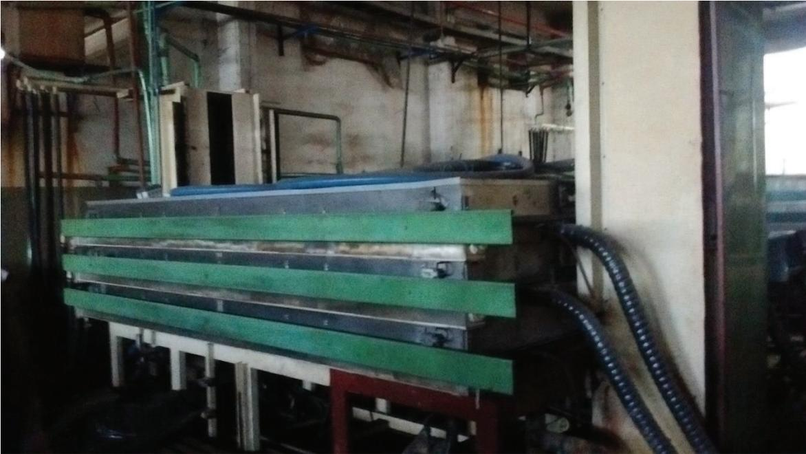
**Figura Anexo 11:** Registro fotográfico - Máquina de sacado al vacío.
