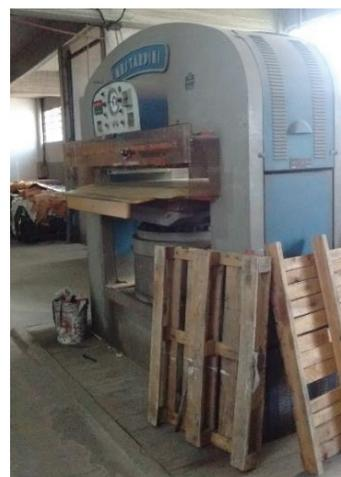
**Figura 7:** Izq: Máquina laminadora con rodillos calefaccionados. Der: Prensa utilizada en el grabado de los cueros. Ambas fotografías fueron obtenidas durante una de las visitas realizadas a curtiembres.
