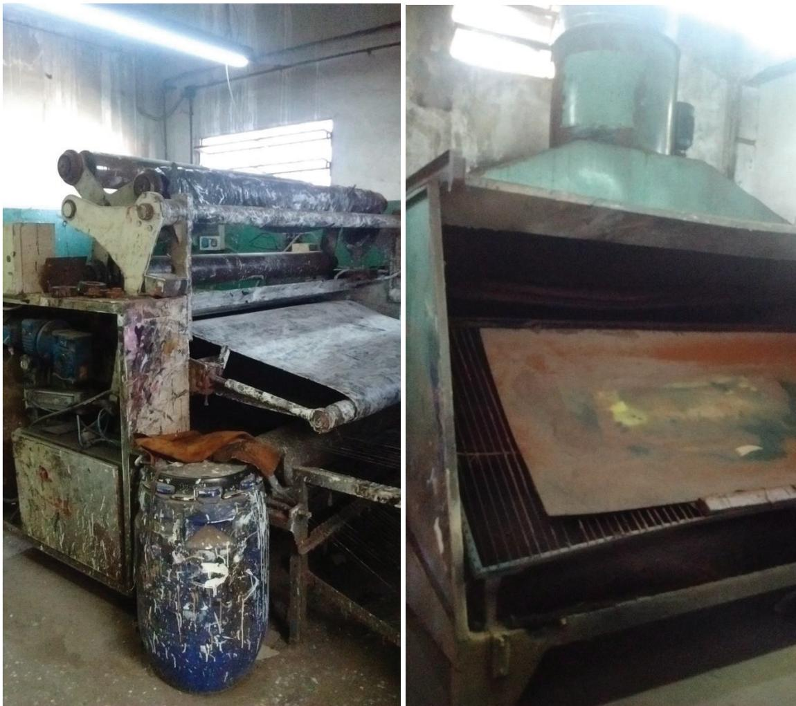
**Figura Anexo 6:** Registro fotográfico - Izq: Aplicación de pintura por rodillos. Der: Cabina para aplicación de pintura por spray.
