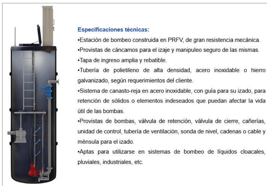
Figura 14: Estación de bombeo prefabricada de la marca Mayper construida con resina poliéster reforzada con fibra de vidrio. Fuente: Mayper.
