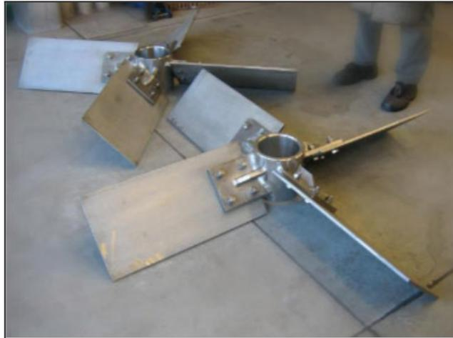
**Figura 15.** Turbina axial de cuatro paletas en un disco para colocar en la cámara de floculación.
