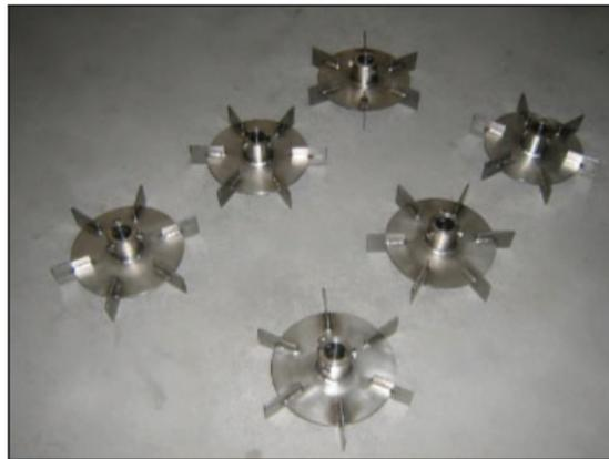
**Figura 13.** Turbina radial de seis paletas en un disco para colocar en la cámara de coagulación.
