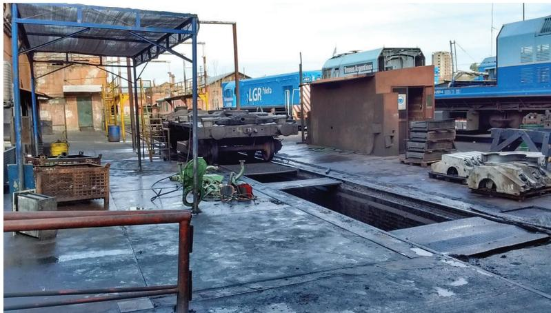
*Fig. XIV: Fosa utilizada para la limpieza de piezas y consiguiente inspección y revisión. (Fuente: Elaboración propia)*
