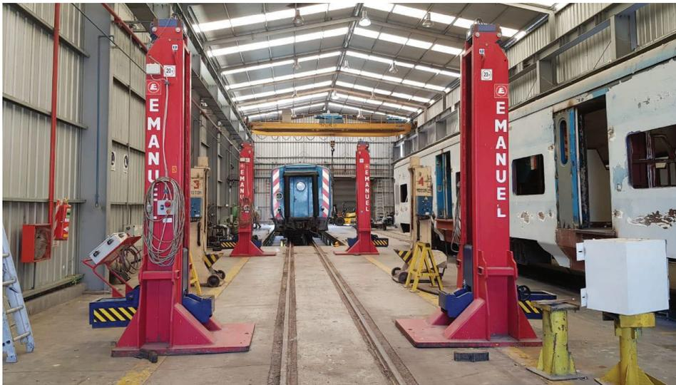
*Fig.XIII: Sistema de elevación para vehículo ferroviario, compuesto por cuatro columnas con uña para sujeción de la maquinaria y elevación por medio de un tablero de control. Fuente: Elaboración propia*
