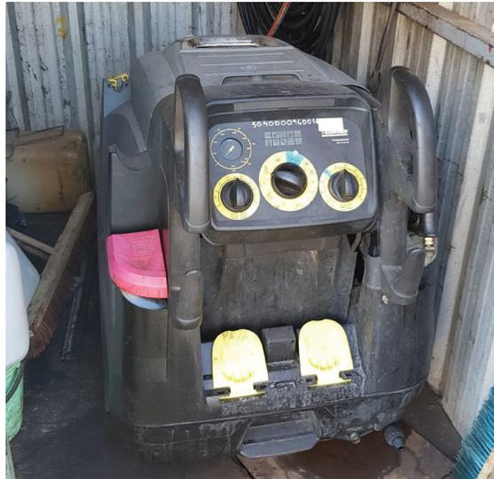
*Fig. XII: Hidrolavadora empleada en el proceso de lavado. Fuente: Elaboración propia*
