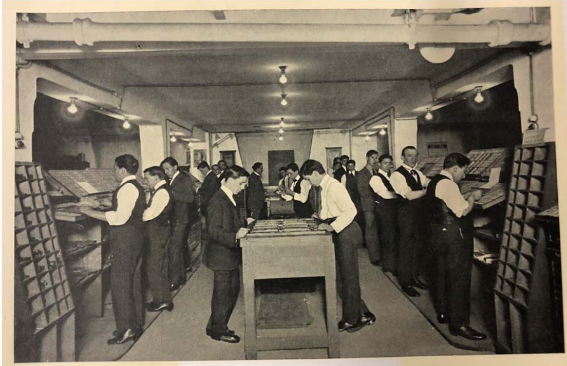
Clase de composición tipográfica en el Instituto Argentino de Artes Gráficas. Los estudiantes se encuentran de pie frente a los cajetines en que están dispuestos los tipos utilizados en la composición. La fotografía (s/f) es cortesía del Instituto Argentino de Artes Gráficas
