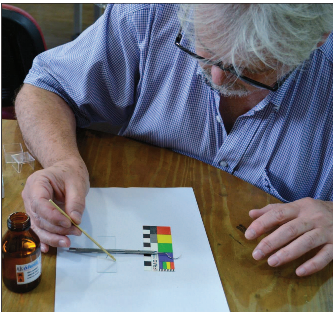
Marcelo utilizando bálsamo de Canadá para sellado de muestra sobre portaobjeto
