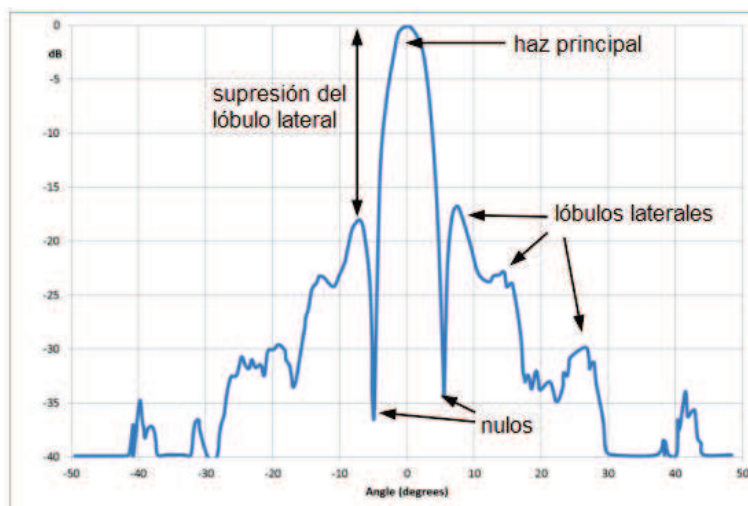
Figura 1.10: Patrón de radiación en coordenadas cartesianas
