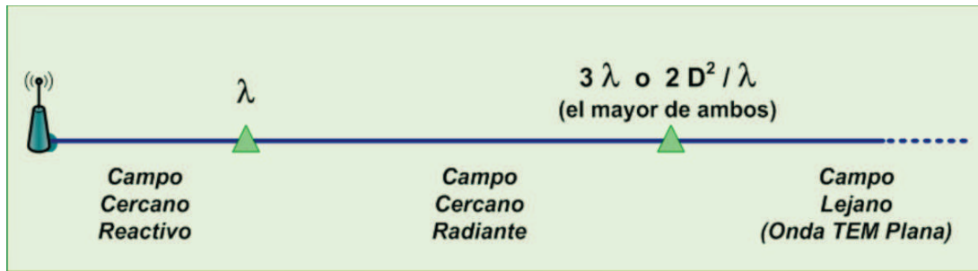
Figura 4.1: Distancia para campo cercano (reactivo y radiante) y campo lejano
