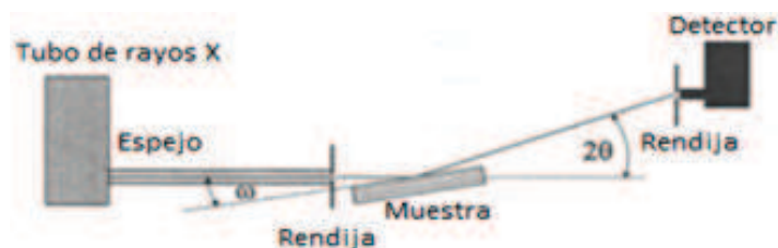
Figura 15: Esquema de las condiciones experimentales, donde se observa, los movimientos en \omega y 2\theta
