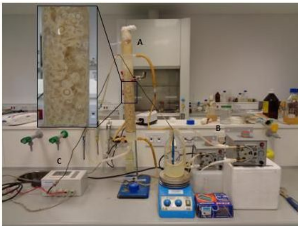
Figura 3.3 Fotografía del reactor de Biofilm . A) Columna con soporte para establecimiento del biofilm . B) Bombas peristálticas para alimentar con medio de cultivo y una solución de NaOH. C) Equipo Consort R305 utilizado para el control automático del pH.
