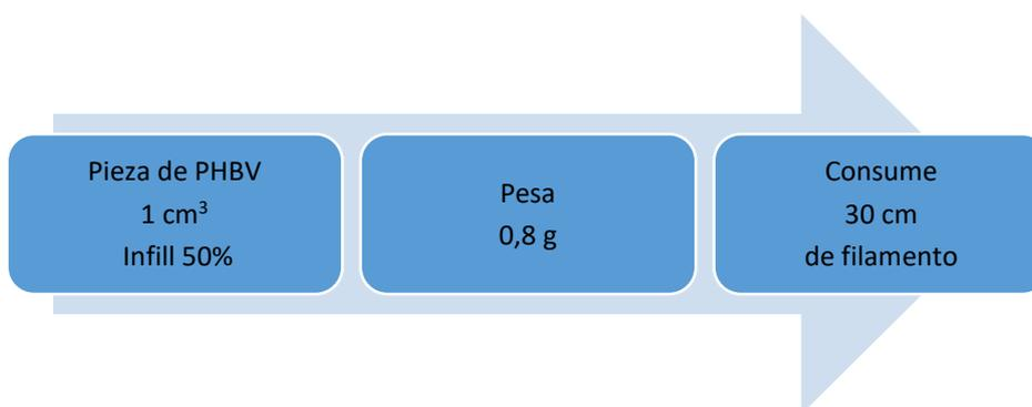
Figura 35 Cantidad de PHBV necesario para imprimir una pieza de 1 cm<sup>3</sup>
