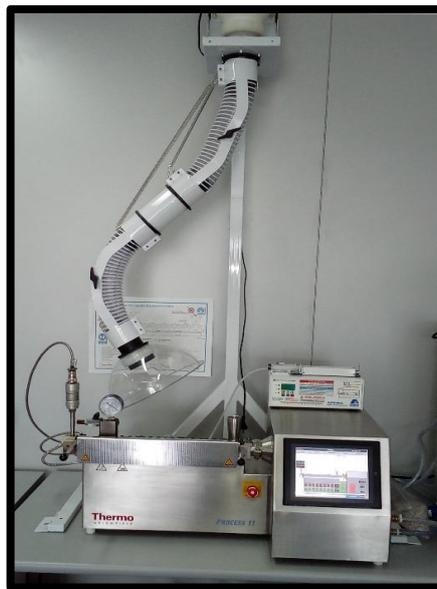
*Figura 8 Extrusora de doble tornillo*
