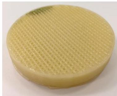
*Figura 42: Pieza cilíndrica impresa con pico de bronze*
