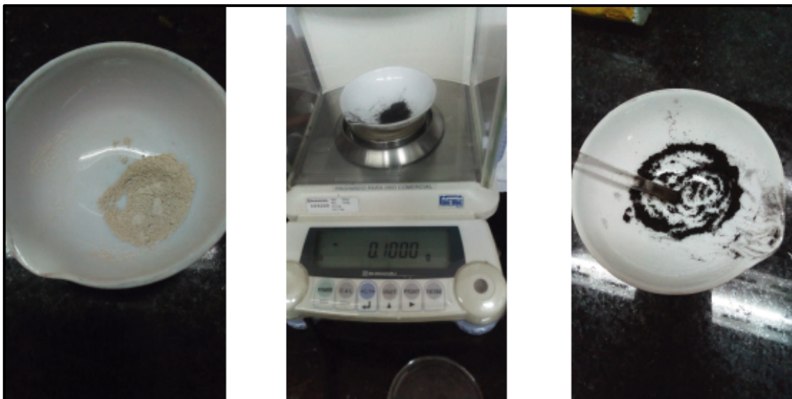
Figura 8: Molienda y pesaje de las materias primas. Izquierda, mineral blanco luego de la molienda. Al centro, pesaje en balanza analítica del pigmento negro. Derecha, proceso de molienda de la carbonilla.
