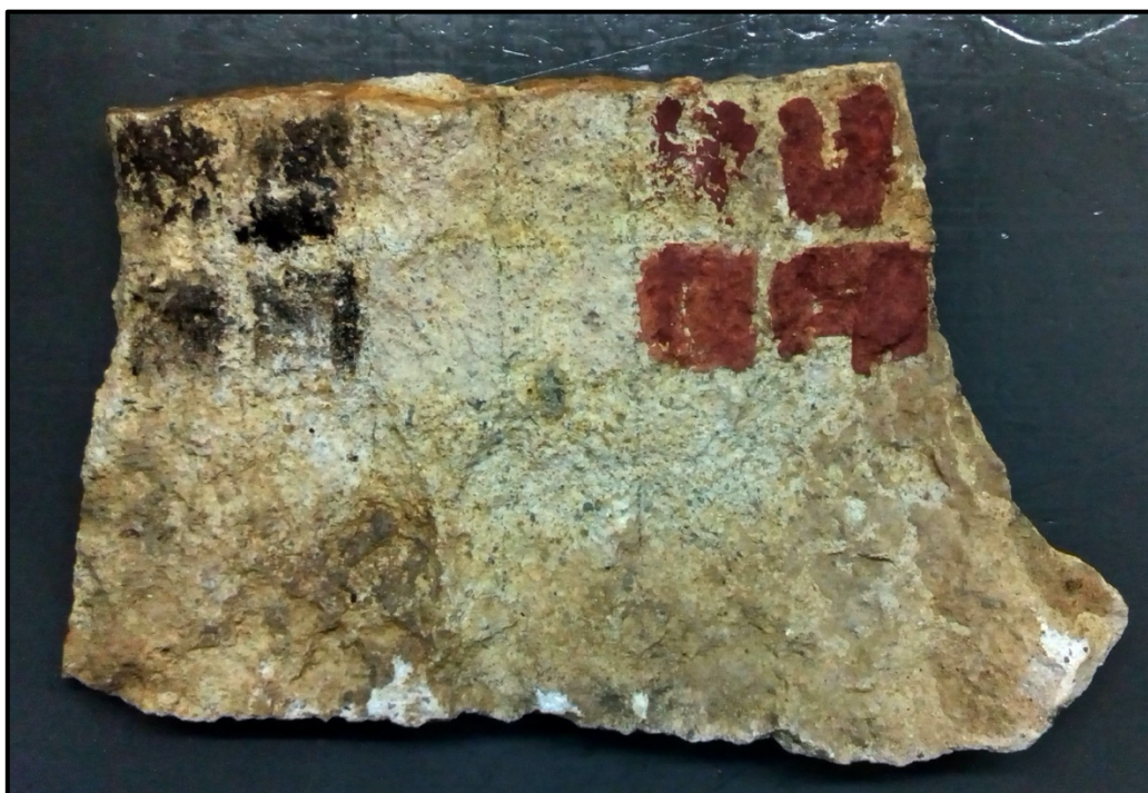
Figura 9: Fotografía de la probeta experimental luego de la aplicación digital y a pincel de las mezclas pigmentarias.
