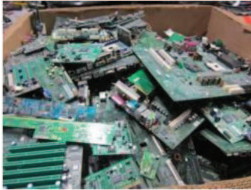
Figura 4-14. Detalle de las tarjetas de circuito impreso obtenidas de RAEE. Recuperado de MITECO, 2016
