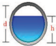
Figura 5-22. Relación entre el diámetro de la cañería y el tirante máximo. Recuperado de Scherdtfeger, 2019.
