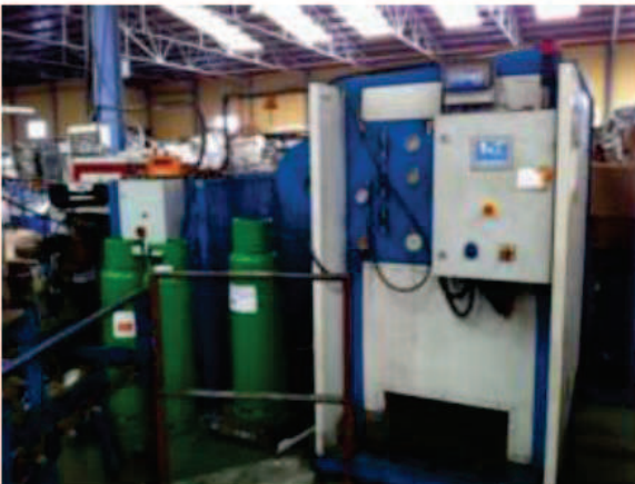
Figura 4-13. Detalle de la máquina de extracción de gases y aceites. Detalle del almacenamiento del aceite y de los gases en bombonas separadas e identificadas. Recuperado de MITECO, 2016.
