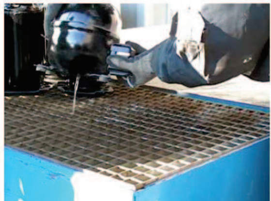
Figura 4-11. Detalle de la extracción del compresor y aceite de una heladera. Recuperado de Fundación Ecolec, 2017.
