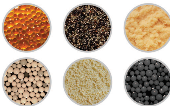
Figura 3.12: Ejemplo de resinas de intercambio iónico: resinas capaces de remover boro, nitratos, sulfatos, entre otros elementos contaminantes del agua, para aplicaciones específicas. Fuente: https://www.vigaflow.com/productos/resinas-de-intercambio-ionico/
