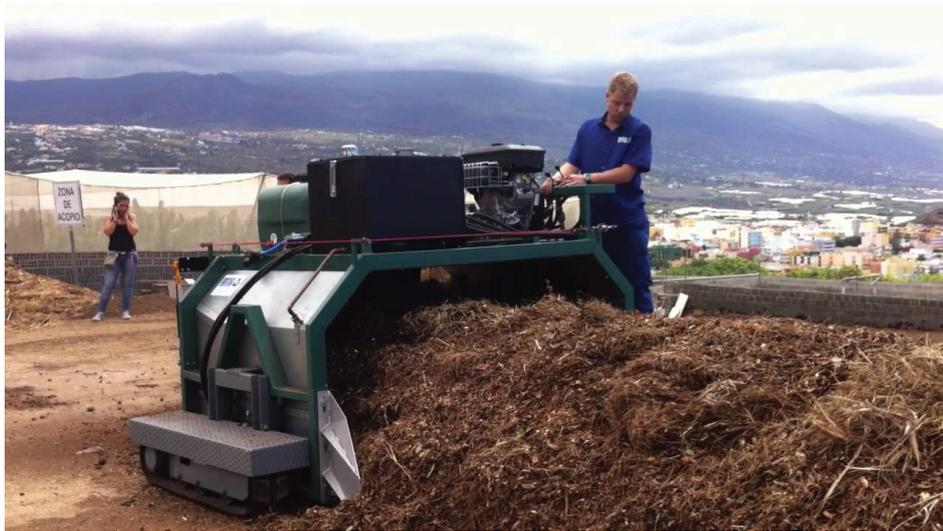
**Foto 30:** Ejemplo de Volteadora Mecánica para Compost
