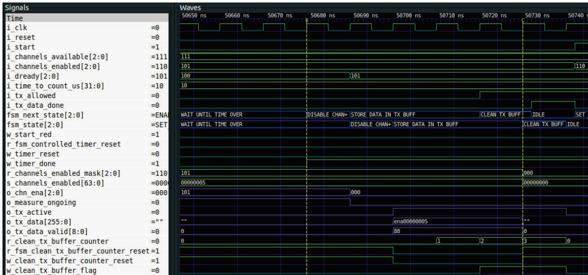
Figura 3.23: Fin de una rutina del ejecutor ce_measure . En el marcador B se observa el momento en el cual el temporizador finaliza y ciclos más tarde se envía el mensaje “ena00000005” a través del buffer de salida global.
