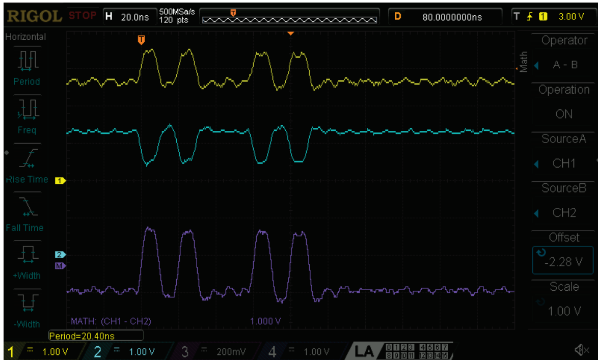
Figura 5.7: Medición del patrón de prueba con una frecuencia base de 100 MHz con el osciloscopio Rigol DS1104-Z Plus. Canal 1: Positivo de la señal TMDS, V_p . Canal 2: Negativo de la señal TMDS, V_n . Canal MATH: Señal TMDS, V_p - V_n .
