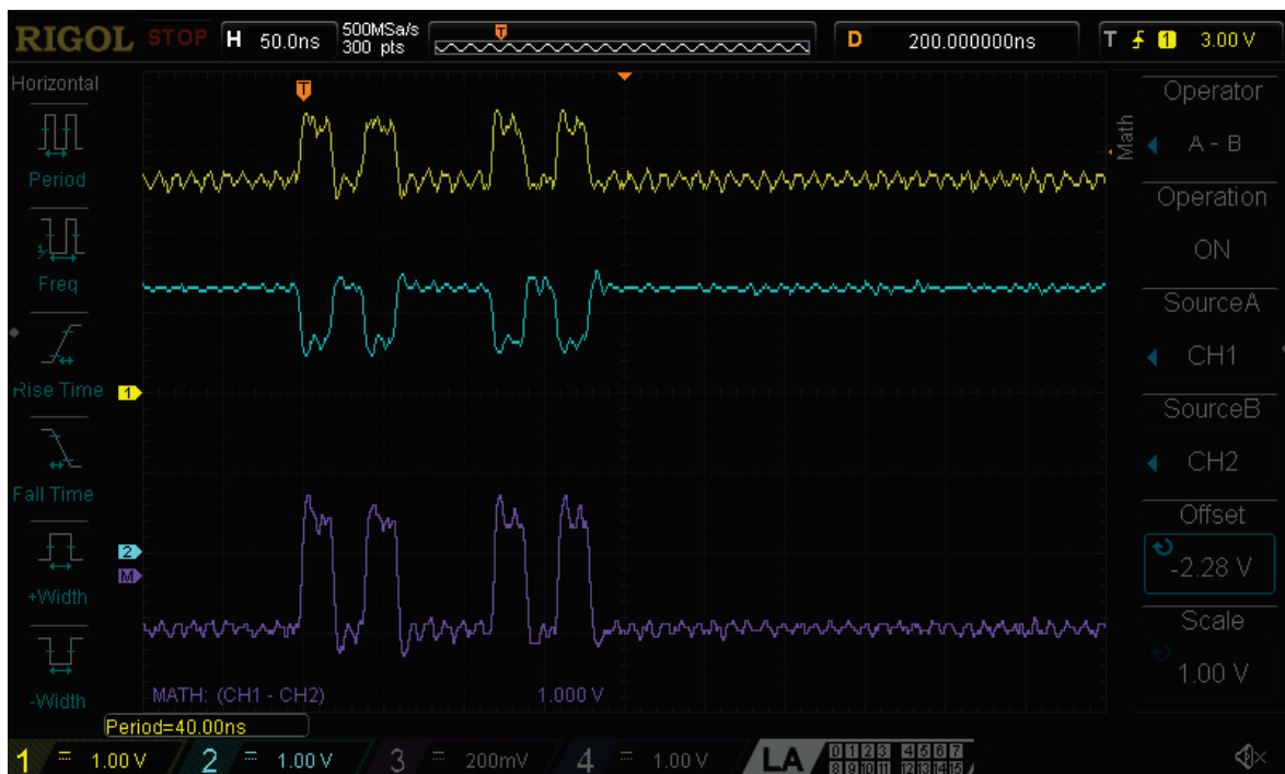
Figura 5.6: Medición del patrón de prueba con una frecuencia base de 50 MHz con el osciloscopio Rigol DS1104-Z Plus. Canal 1: Positivo de la señal TMDS, V_p . Canal 2: Negativo de la señal TMDS, V_n . Canal MATH: Señal TMDS, V_p - V_n .
