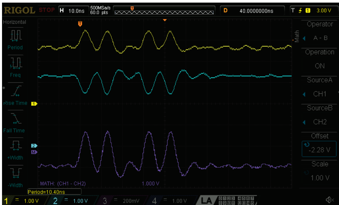
Figura 5.8: Medición del patrón de prueba con una frecuencia base de 200 MHz con el osciloscopio Rigol DS1104-Z Plus. Canal 1: Positivo de la señal TMDS, V_p . Canal 2: Negativo de la señal TMDS, V_n . Canal MATH: Señal TMDS, V_p - V_n .
