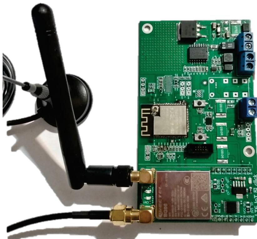
FIGURA 4.1. Placa montada del módulo master
