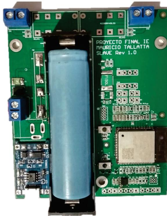
FIGURA 4.2. Placa montada de un módulo esclavo
