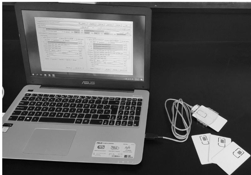
Figura 4.4 – Conexión y configuración de grabadora de tarjetas
