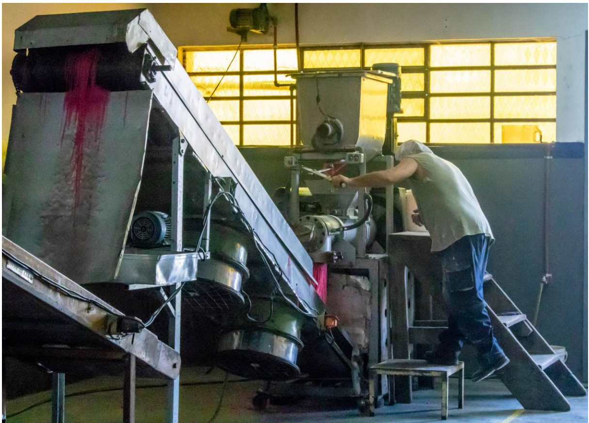
Fotografía 21. En el sector izquierdo de la planta baja al fondo, uno de los trabajadores comienza la producción de granas. Al final de la escalera, nos encontramos con la parte de la máquina que realiza la mezcla de la pasta que conformará la grana. Hacia el medio, nos encontramos con la pasta de grana rosa que sale en forma de fideo, se translada por la cinta, y se comprime en la parte superior. Luego, pasará por otra cinta hasta llegar a los cajones donde se depositan para luego ser llevadas a las pailas que las cocinarán. Imagen de Octubre de 2018.
