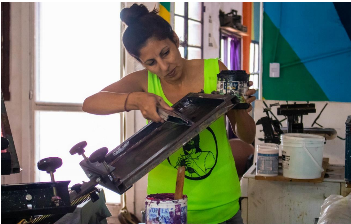
Fotografía 2. Una emulsión es puesta por encima del fotolitio para ser expuesta a la luz. Imagen tomada en Febrero de 2019
