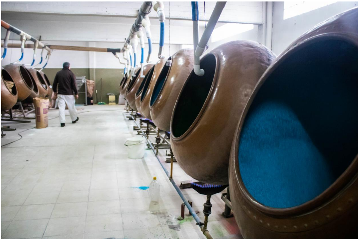
Fotografía 29. En el primer piso, nos encontramos con dos filas de pailas. Las de la izquierda, sin funcionar por falta de conexión de gas. Las de la derecha, produciendo grana de color azul, bajo la supervisión de uno de los trabajadores que las recorre para controlar el proceso. Imagen de Abril de 2018.
