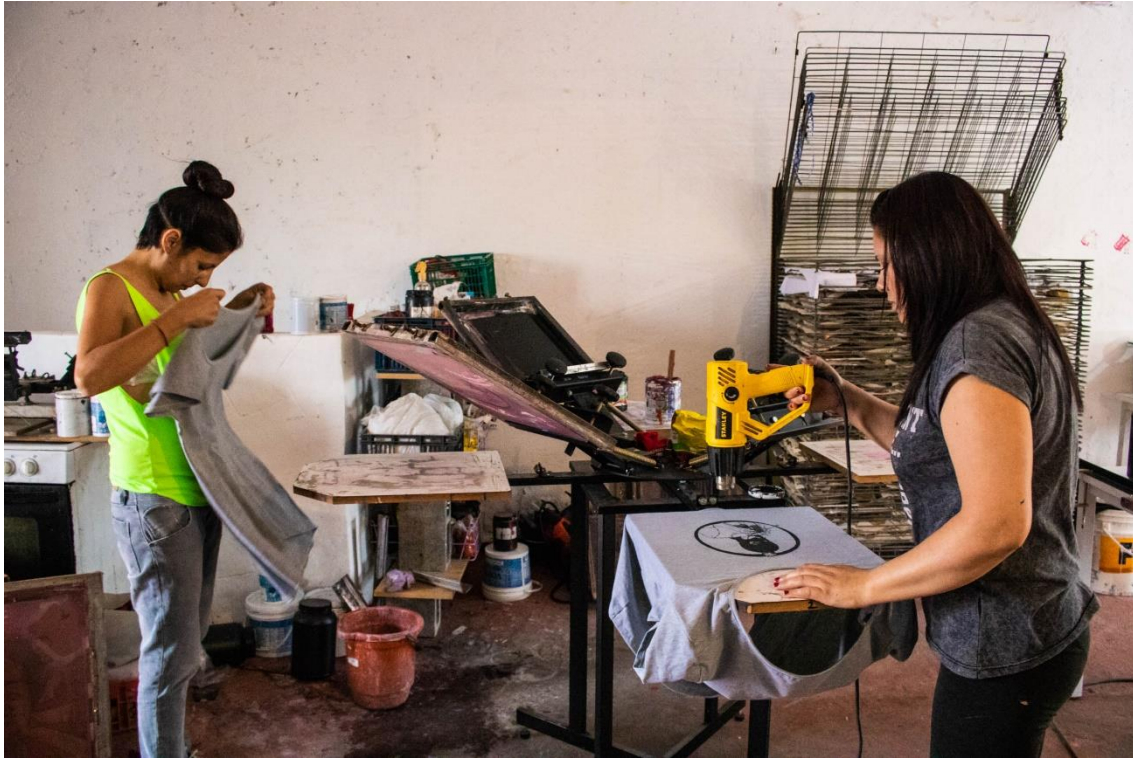
Fotografía 13. Trabajo sincronizado en el "pulpito". Mientras una graba las remeras, otra seca los diseños con la pistola de calor. Imagen de Febrero de 2019.
