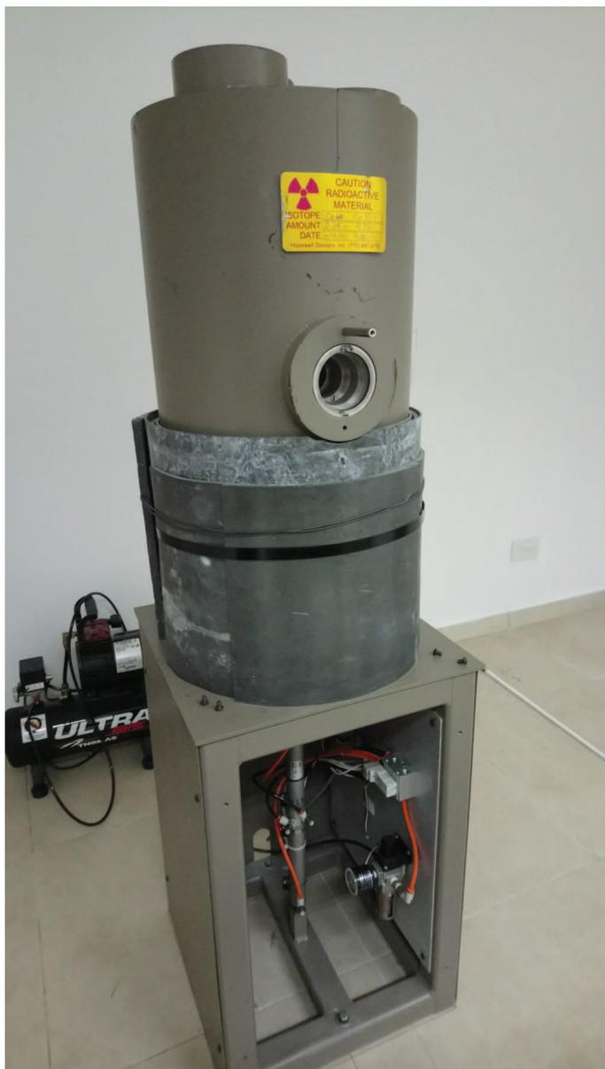
Figura 4.11: Dispositivo de irradiación Hopewell del Departamento de Dosimetría de Radiaciones Ionizantes (CAE, CNEA).
