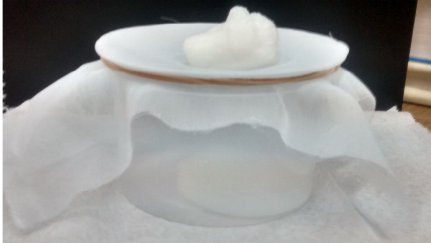
Figura 4.12: Recipiente de polietileno con el disco de parafina, cubierto por una tela porosa de nylon y con un algodón embebido en una solución de imidacloprid y sacarosa.
