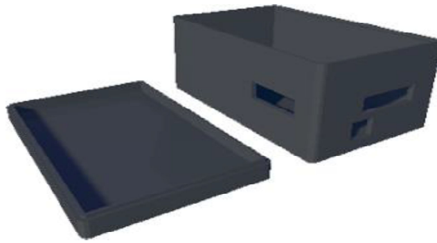
Fig. 31 Renderizado de la caja impresa en 3D para contener la electrónica
