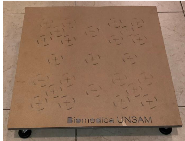
Fig. 42 Plataforma con la plantilla grabada en láser para la medición del CoP estático
