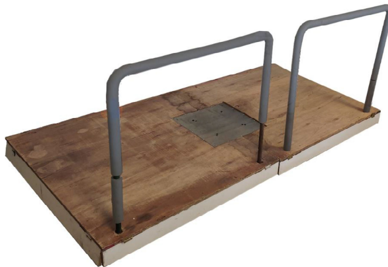
Fig. 32 Pasarela utilizada para las mediciones dinámicas
