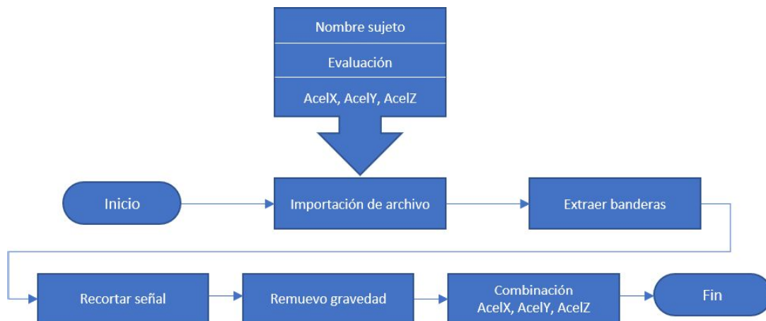
Fig. 20: Diagrama en bloques de la rutina acondicionamiento de señales. Al importar un archivo previamente generado por el sistema de adquisición y procesamiento se discriminan los datos y se guardan en una matriz. Los datos de aceleración incluyen la señalización de eventos, por lo que se extraen. Utilizando esta información se procede a la selección y recorte de las señales, para luego remover la gravedad utilizando un filtro pasa altos. Como último paso se combina la información de las señales en una aceleración promedio.
