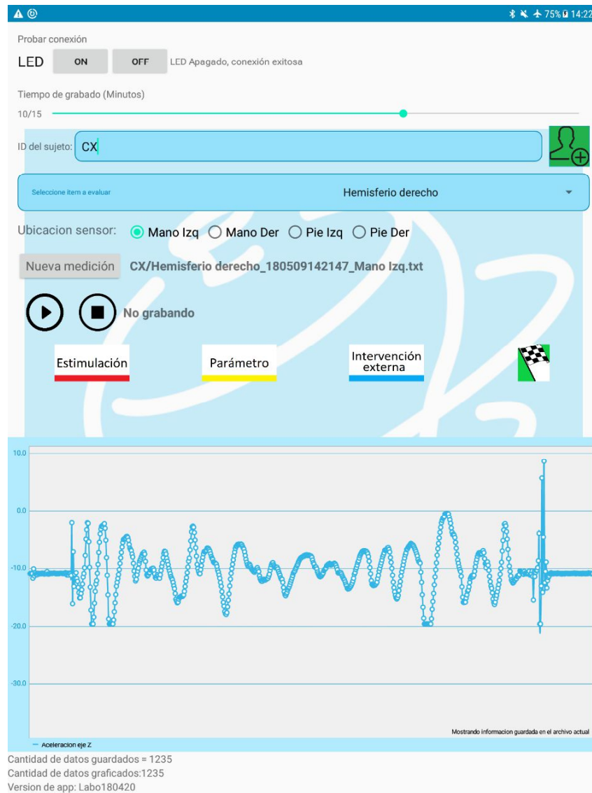
Fig. 19: Interfaz de la actividad principal de la App Acquisition CX. En la región superior se puede ver el sector de prueba de conexión. En la sección media se ingresan los parámetros de adquisición: un slider para seleccionar el tiempo máximo de grabado, un campo donde se ingresa el nombre del sujeto y un menú deslizable donde se elige el hemisferio bajo estimulación. Luego se encuentran los botones de control de grabación, para crear el archivo de nueva medición y los botones de grabar y no grabar. Los botones de banderas permiten señalar eventos, como el inicio de la estimulación, algún cambio en los parámetros de la misma o una intervención externa.
