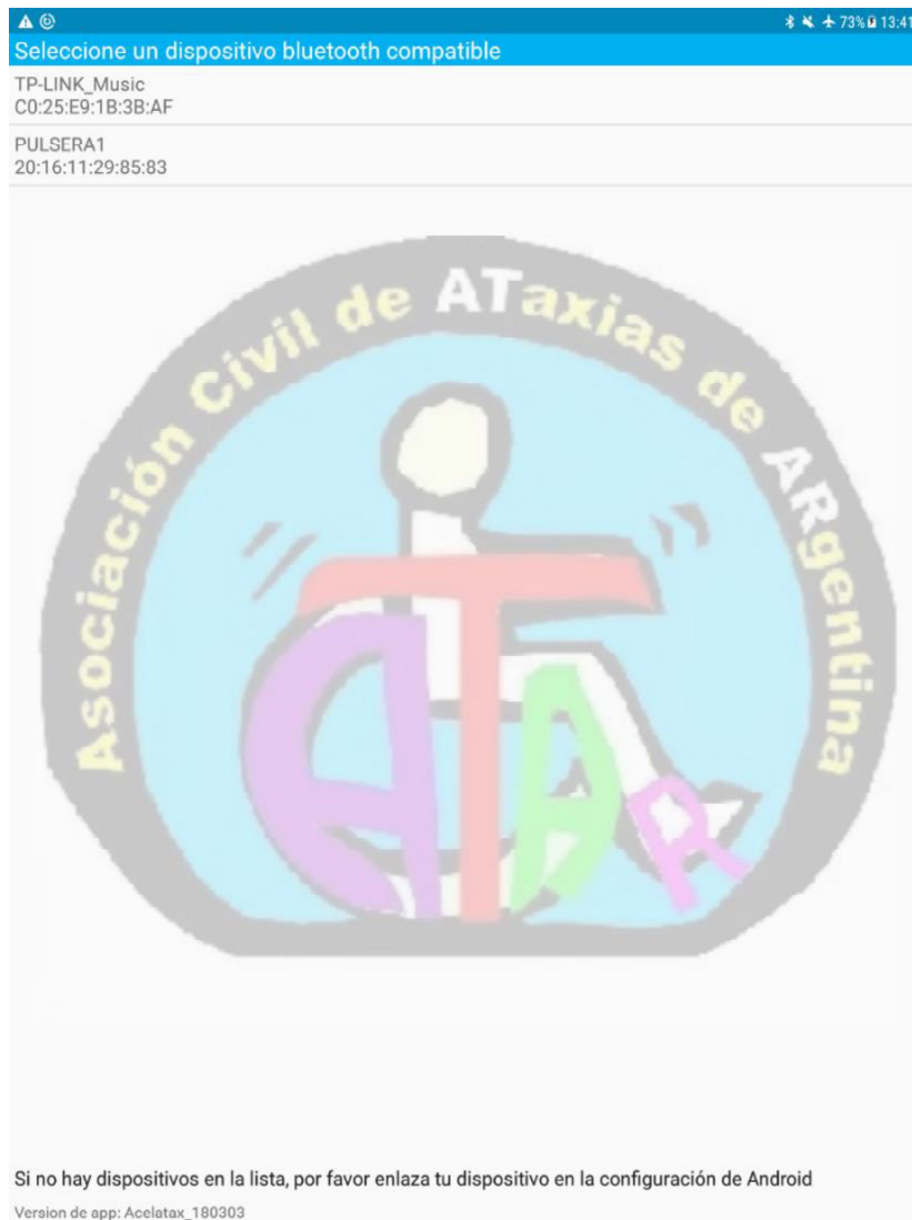
Fig. 11: Interfaz de la actividad selección en la App Adquisición Ataxia. Se muestra una lista de los dispositivos previamente emparejados.
