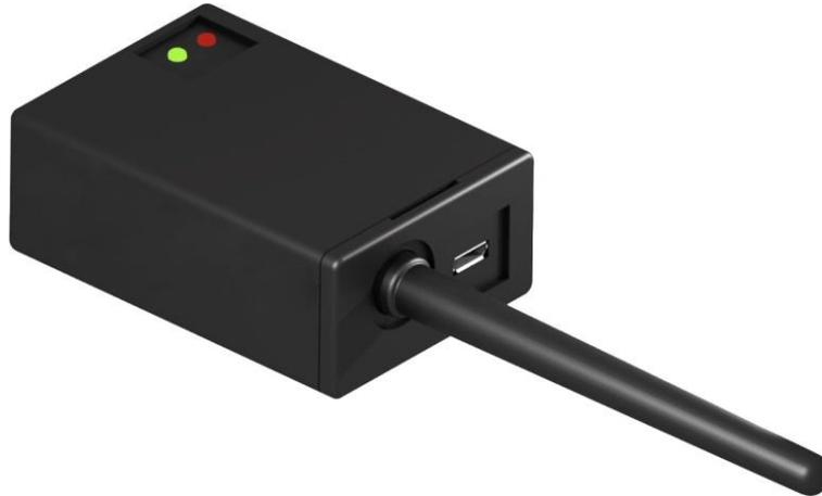
**Fig. 42. Sistema de recepción. Vista isométrica donde se pueden ver los LEDs indicadores de estado, el puerto USB y la antena de alta ganancia del módulo de transrecepción.**
