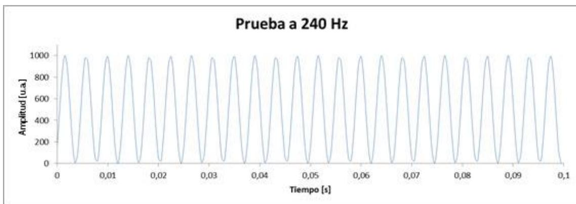
**Fig. 51. Ensayo de prueba de adquisición. Señal generada mediante un generador de frecuencias arbitrarias seteado en onda senoidal de 240Hz, amplitud  $4.8 V_{pp}$  y offset de 2.4V.**
