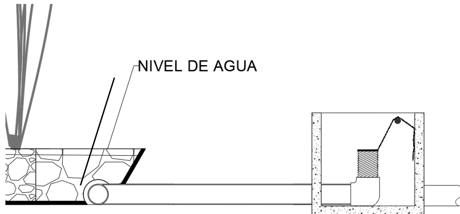
Figura 5.9: Cámara de nivelación de altura de agua.
