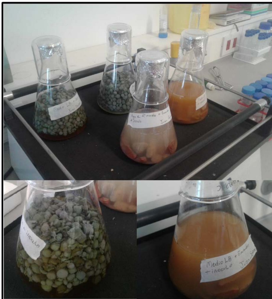
Figura 4.8: Experimentación con escombro y leca plástica como medio soporte de biofilm.
