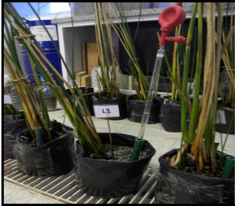
Figura 4.12: Aforo para el control de volumen de agua y extracción de muestras con pipeta.
