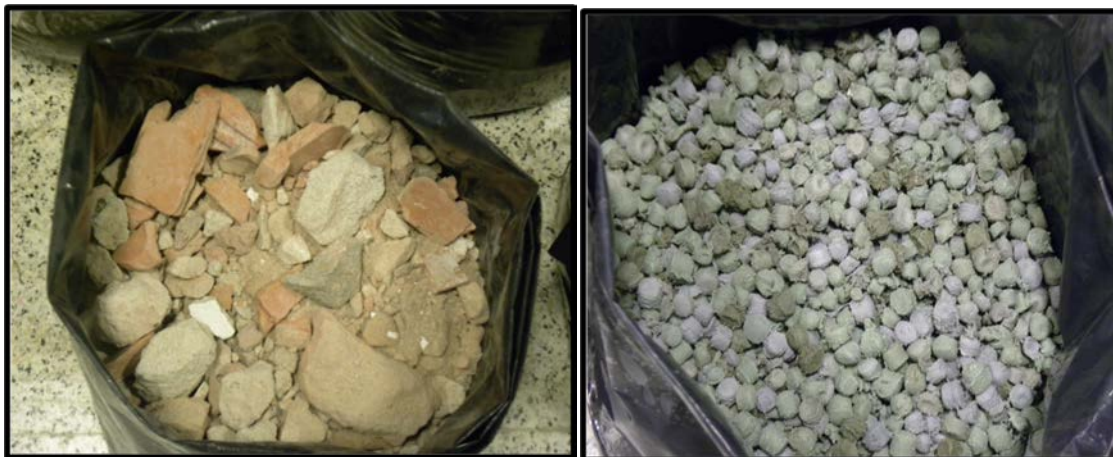
Figura 4.5: Sustratos utilizados para la experimentación batch: Lecas plásticas (izq.) y escombros de obra (der.)
