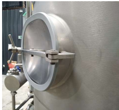
Figura 6-12. Vista lateral de la compuerta propuesta para la tolva de carga (Fuente: Elaboración propia).
