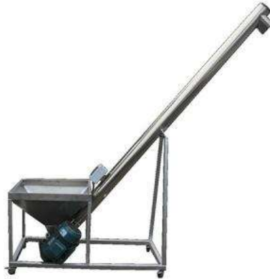
Figura 6-10. Ejemplo de tornillo sinfín para la carga del reactor de sólidos con el bagazo proveniente del reactor de macerado (Fuente: autor desconocido).
