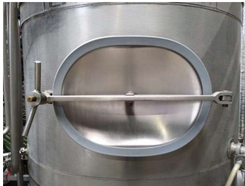
Figura 6-11. Vista frontal de la compuerta propuesta para la tolva de carga (Fuente: Elaboración propia).
