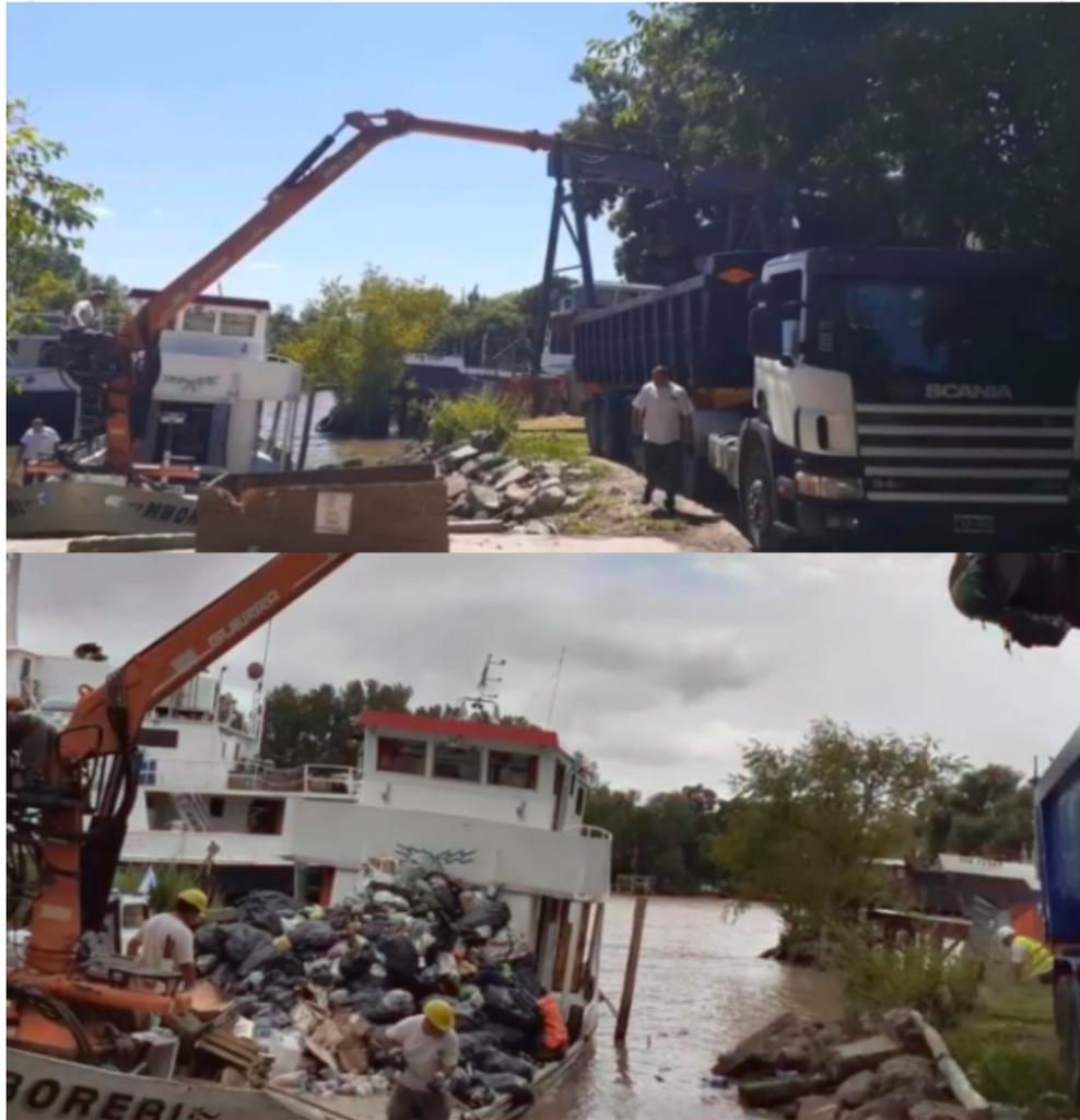
Figura 2.8: Sistema de descarga de las chatas encargadas de la recolección primaria. Fuente: Grupo Riccitelli.
