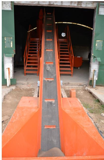
*Figura 4.27:* Ejemplo de tolva receptora de residuos. Fuente: Planta de separación de la municipalidad de Chivilcoy.
