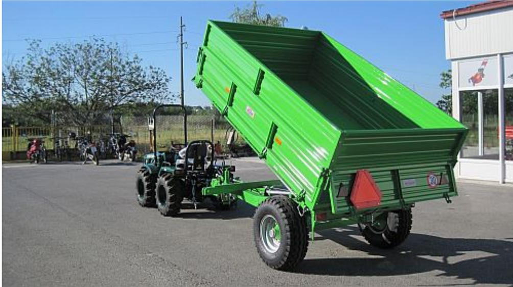
Figura 4.25: Ejemplo de remolque volquete transportador de residuos. Fuente: Hitnner.
