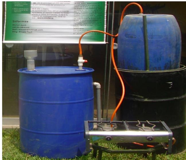
Figura 4.48: Ejemplo de biodigestor domiciliario con gasómetro de campana flotante. Fuente: Eawag, 2014.
