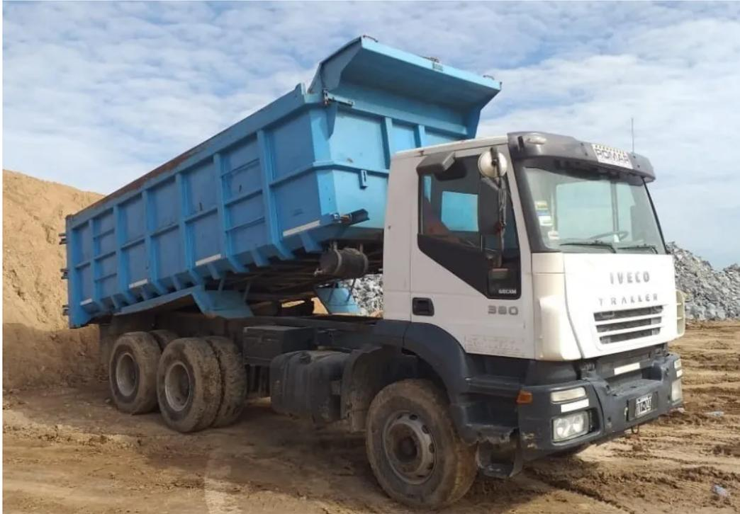
*Figura 4.34:* Camión volcador transportador Iveco modelo Trakker 6x4. Fuente: IVECO.
