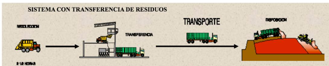
Figura 3.1: Diagrama de un sistema de transporte de residuos con estación de transferencia. Fuente: Ing. Carlos A. Fontán, 2005.
