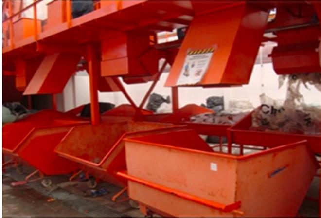
Figura 4.30: Ejemplo de carros con ruedas para descarga de los residuos clasificados.
