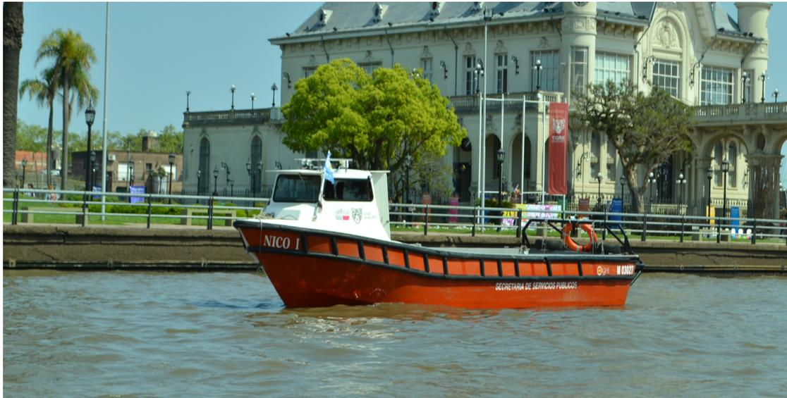
*Figura 2.9:* Lanchas Benavidez Cabinadas de 9,8 m de eslora utilizadas por la empresa Grupo Riccitelli para la recolección de RSU de las islas del Delta Tigre. Fuente: Grupo Riccitelli.
