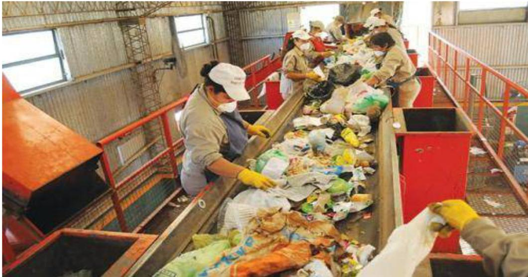
Figura 4.29: Ejemplo de cinta de clasificación de residuos. Fuente: Cooperativa CURA.
