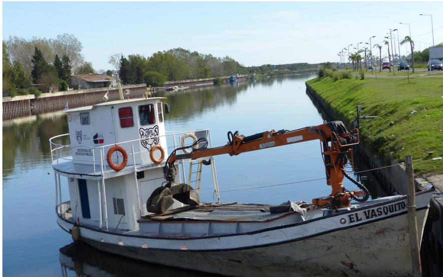
*Figura 2.10:* Chata de 14,7 m de eslora utilizadas para la recolección de RSU de las islas del Delta Tigre. Fuente: Grupo Riccitelli.
