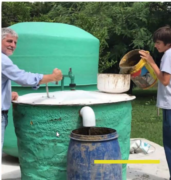
Figura 4.49: Ejemplo de biodigestor domiciliario para grandes generadores, con gasómetro y agitación mecánica manual. Fuente: GEA Sustentable, 2020.
