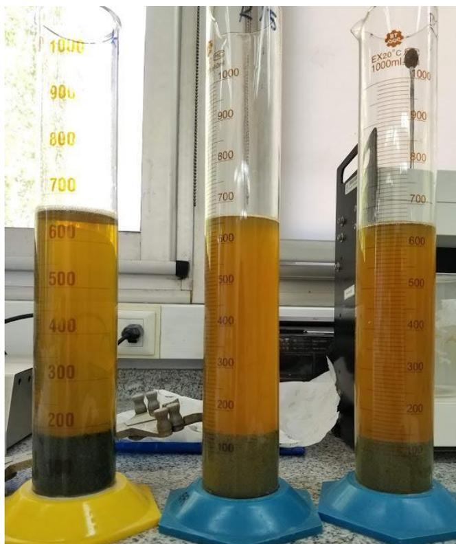
Figuras 4.4.11: Ensayo Fenton (Decantación de barros)
