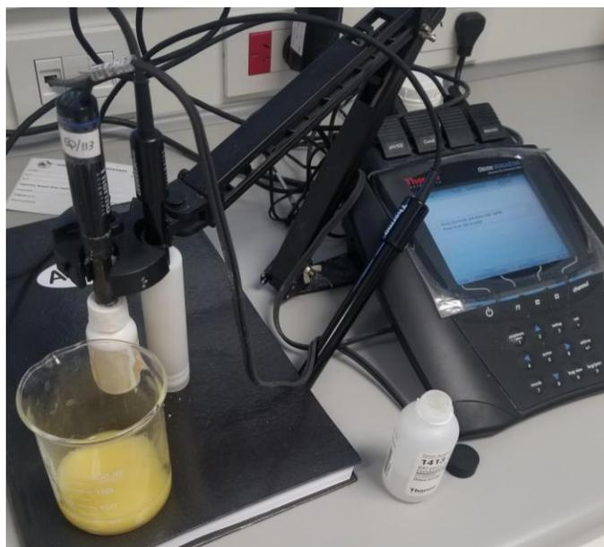
Figura 4.4.4: Medición de conductividad y pH
