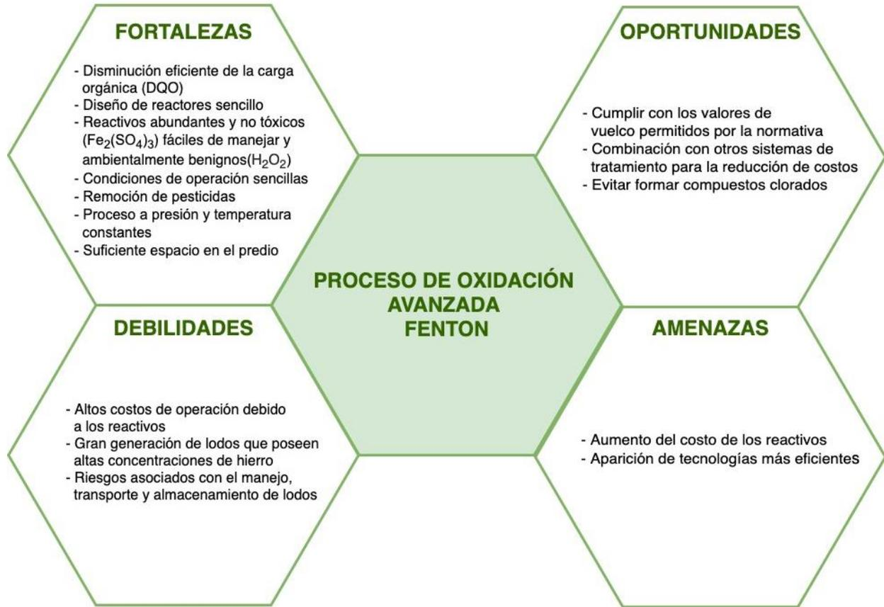
Figura 3.7.1: Análisis FODA del sistema de tratamiento con un proceso de oxidación Fenton
