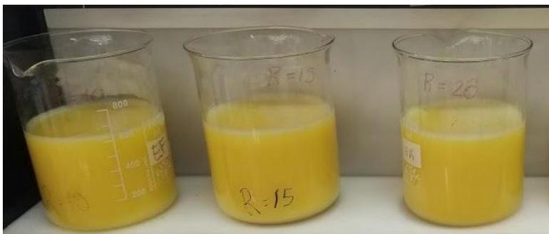
Figura 4.4.7: Ensayo Fenton (Equipo Jar test antes del agregado de reactivos)
