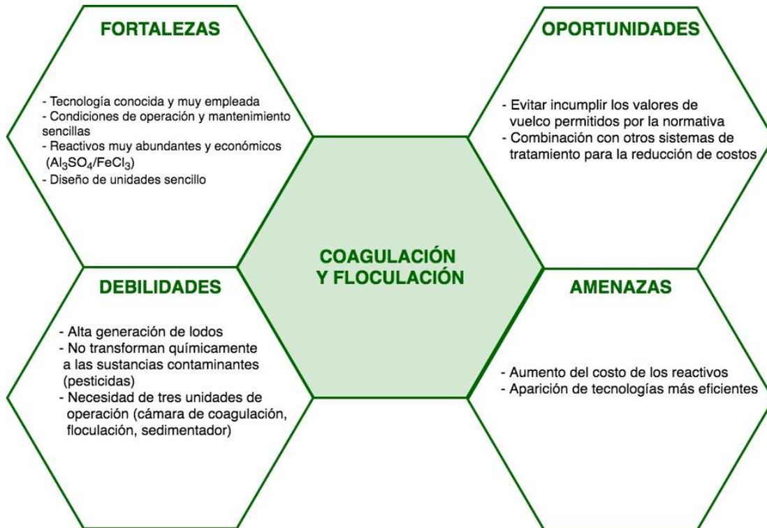
Figura 3.7.2: Análisis FODA del sistema de tratamiento con un proceso coagulación y floculación
